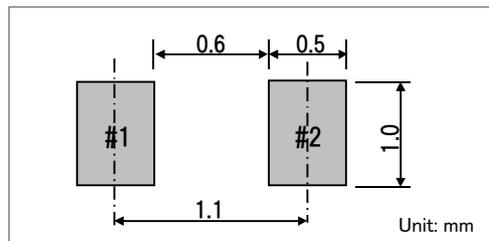
備考：回路基板設計の際は、水晶振動子搭載部（下面）に回路パターンを設けないでください。
